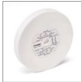
Slijpschijf edelkorund ø 150 x 20 x 15 mm, korrel 100 art. 700392
