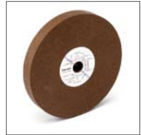
Slijpschijf normaalkorund ø 200 x 25 x 15 mm, korrel 80 art. 700183
