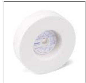
Komslijpschijf edelkorund ø 150 x 40 x 15 mm, korrel 100 art. 700139
