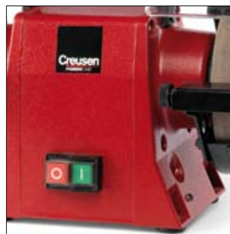
Schakelaar in midden van machine biedt bedieningsgemak
