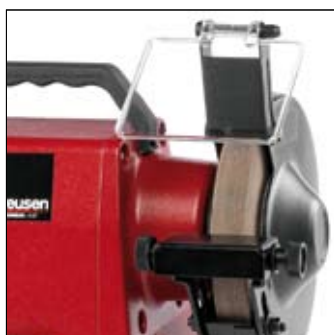
Stabiele dubbelzijdig bevestigde slijpsteunen
