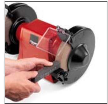
Handdresser voor het opruwen, corrigeren en reinigen van de slijpschijf
