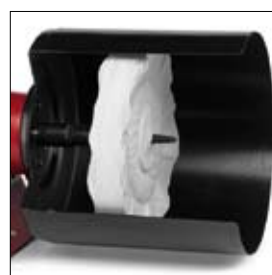
Polijstkappen zorgen voor veiligheid tijdens polijst- werkzaamheden
