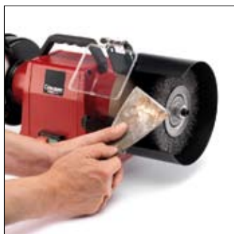
Staaldraadborstelset voor ontroesten of ontbramen
