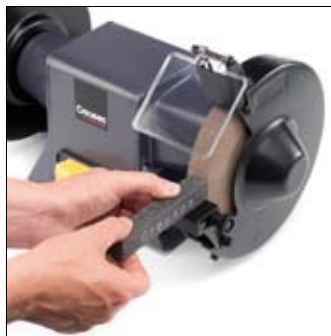
Handdresser voor het opruwen, corrigeren en reinigen van de slijpschijf
