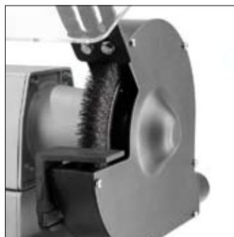
Staaldraadborstel veilig binnen de beschermkap te monteren
