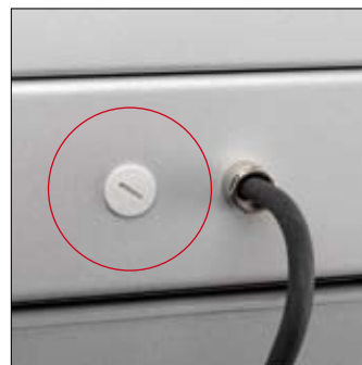
De achterzijde van de machinevoet is voorzien van een tweede aansluitpunt voor montage op kolom AK 9000HD
